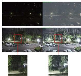
야간 시인성 개선 성능 비교 (좌 - 일반 CCTV 화질; 우 - 개선 영상)
