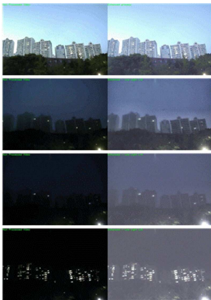
조명 없는 상황에서도 상황에 맞는 단계별 개선 영상 제공 (좌 - 일반 CCTV 화질; 우 - 개선 영상)
